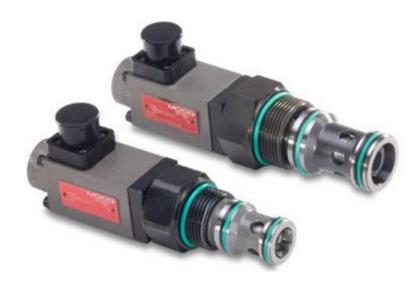
2 vías Rosca Válvulas de cartucho proporcionales se utilizan para regular los flujos de puerto "A" a "B" Las válvulas utilizan un diseño hidráulico de auto-regulación para el control de una velocidad de flujo por una señal PWM controlado por corriente.
